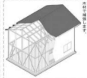
日本では昔から使われてきた工法で、木材で組んだ軸に耐震材(柱)を組んで、その間に梁(梁)を組んだ木造の家です。柱は柱頭(柱頭)に力を伝えるために、梁を支える柱頭を組んだ木造で構成されています。
